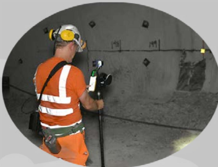
**Analyse de convergence :** Examiner la déformation des roches sans perturber la production pour une sécurité accrue.
